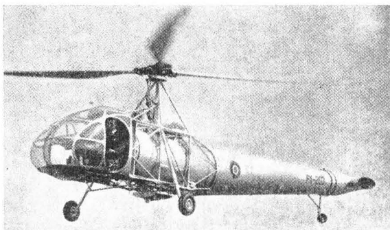
Moderno vijačno letalo z vijakom na štiri liste s spremenljivim hodom, ki ga žene majhen reakcijski motor s storilnostjo 330 KS. Ta puha svoje pline iz ozke odprtine na koncu konicastega trupa.
